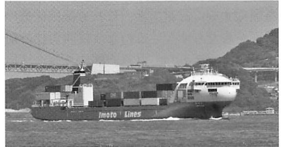
写真4 旭洋造船建造の内航コンテナ船「ながら」は、球状の船首ブリッジをもち、風圧抵抗の削減に成功している。
