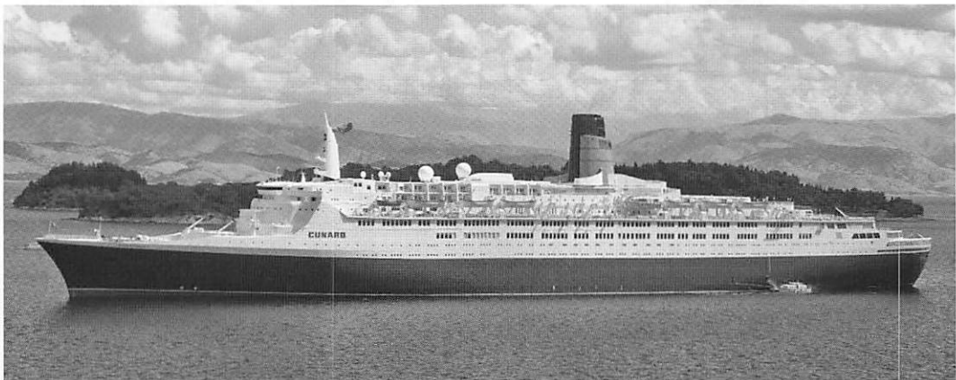
写真2 ブリッジの前面を丸く、船尾甲板を徐々に傾斜をつけて下げて流線形を保った「クイーン・エリザベス2」
