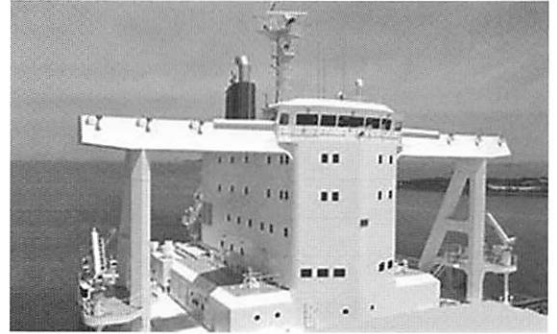
写真7 徹底した風圧抵抗削減効果の取入れて上部構造物の空気抵抗低減を実現した今治造船の開発した「エアロシタデル」。海賊対策も取り入れられた。
