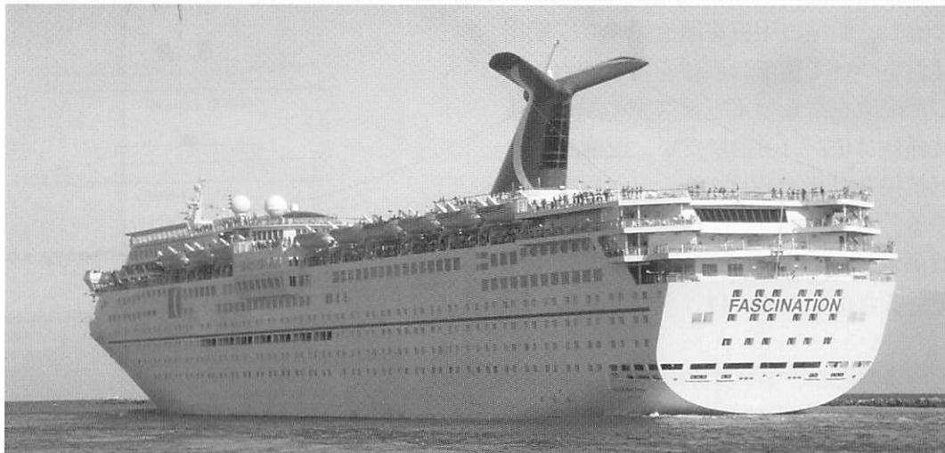
写真3 1980年代のクルーズ客船は、船内容積をできるだけ大きくするためにボックス形状となり、ティッシュボックス型と呼ばれて、風圧抵抗はあまり考慮されなくなった。
