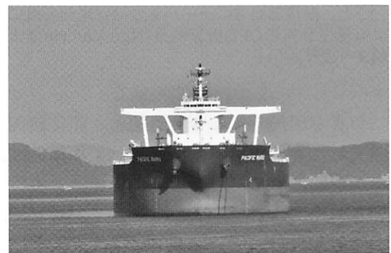
写真6 上部構造物を縦長にして正面投影面積を減らすことで風抵抗を減らした大型ばら積み船。
